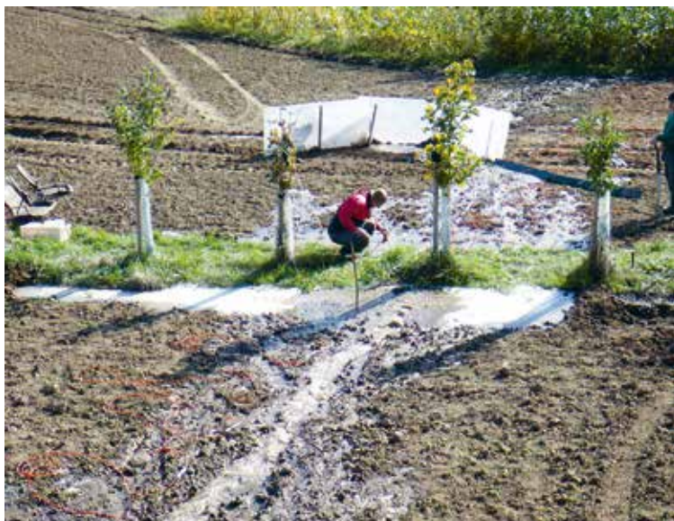
Přelivový experiment se simulací rýhové eroze (10 m 3 /16 min), vlevo zadržování proudu nad jednořádkovým agrolesnickým systémem, vpravo kontrolní experiment – kypřený úhor, výsev pšenice). VÚMOP, VÚKOZ, 2023-2024.
