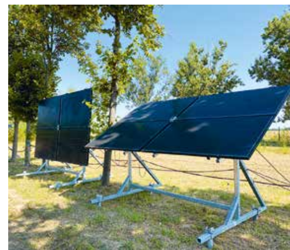
V rámci zvýšeného zájmu o agrovoltaiiku se v Michovkách testuje umístění fotovoltaických panelů v příkmenném pásmu dřevin. Osvědčily se bifaciální (oboustranné) panely. Energie se využívá pro provoz výzkumné stanice a pro vysoušení energetické štěpky.
