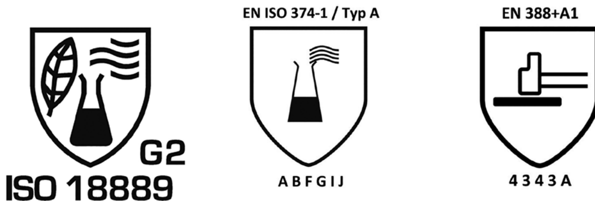
Obr. 1: Některé piktogramy pro označení ochranných rukavic. Vlevo: proti pesticidům (pro „vyšší“ riziko – G2). Uprostřed: proti chemikáliím podle ČSN EN ISO 13688 (pod piktogram se uvádí písmena určující, proti čemu byly rukavice testovány, například ABFGIJ). Vpravo: proti mechanickým rizikům (čísla pod piktogramem značí určitou odolnost, například 4 3 4 3 A).
